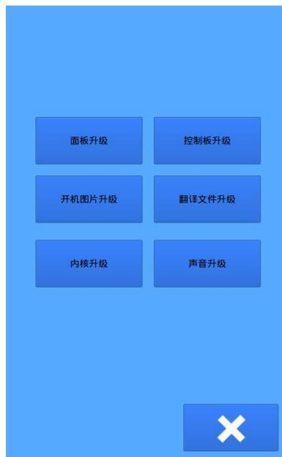
1) **面板升级**：升级前需要将新版本程序panel，wxpanel文件和qm文件夹一起复制到U盘主目录，将U盘插入面板，然后通过“菜单”-->“辅助设置”-->“系统升级”进入到系统升级界面，点击
